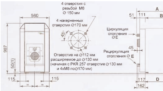
(1) Регулируемые ножки: исходная высота 50 мм, регулируется от 35 до 65 мм
